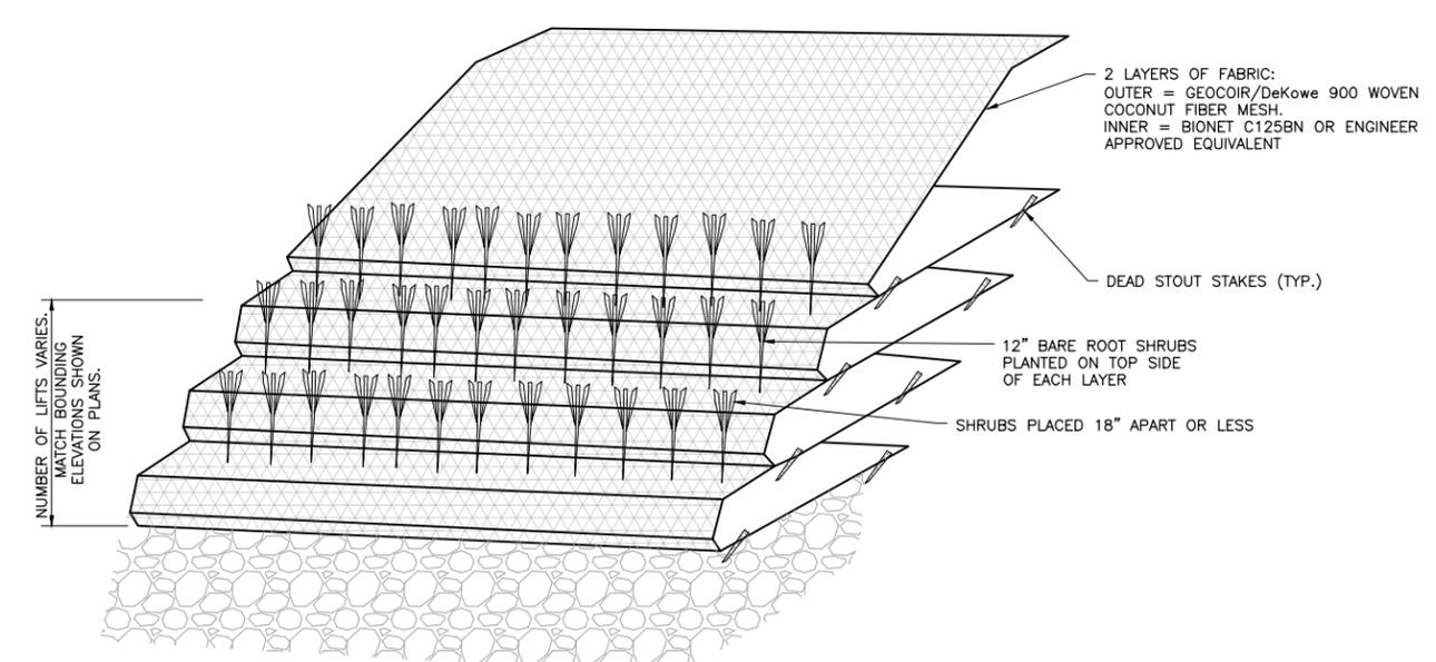
**1 DETAIL: LIVE PLANT VEGETATED REINFORCED SOIL SLOPE (V.R.S.S.)**
